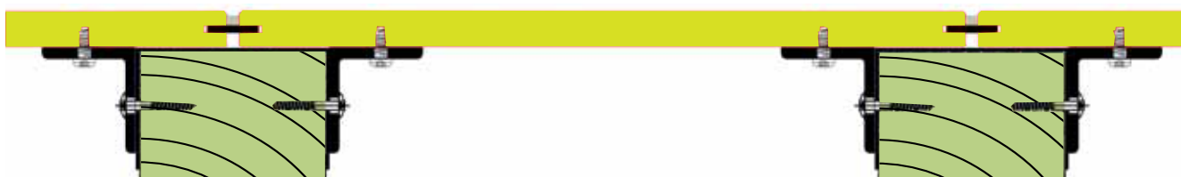
Balkonbodemplaat op houten draagbalken blind bevestigd (geschroefd)
