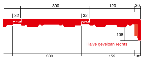
Dekkende breedte halve gevelpan rechts = 12,0 cm
